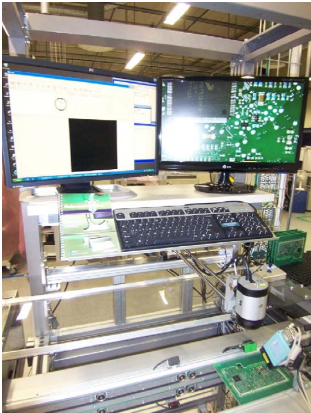
Photo 2 : Autoliv utilise des instruments avancés afin d'inspecter les composants traversant ou montés en surface ainsi que leurs joints de brasage. Afin de savoir
