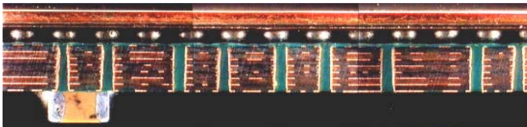
Coupe sur une ligne de billes de BGA
